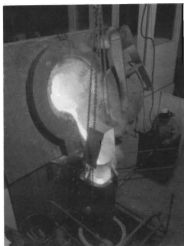
3 トン誘導溶融炉からの注湯状況
